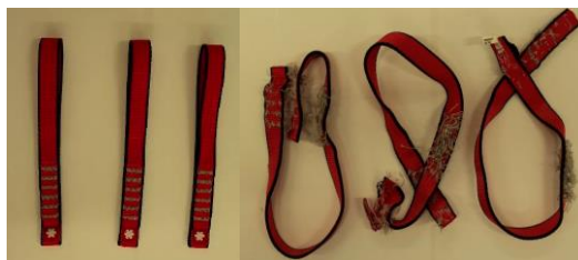
Rys. 2. Próbkki nylonowe: nowe i po próbie
